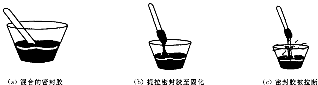
图 D.4 拉断时间试验
